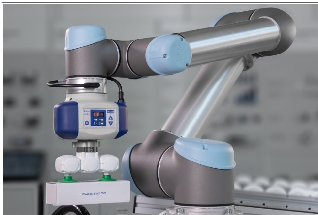
Generador de vacío eléctrico ECBPi en el manejo de cajas de cartón
